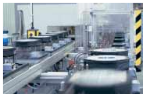
A SINISTRA: SISTEMA DI MONTAGGIO FLESSIBILE, CON UNA CAPACITÀ DI 1.000 FRENI IN DIVERSE VARIANTI PER TURNO.
